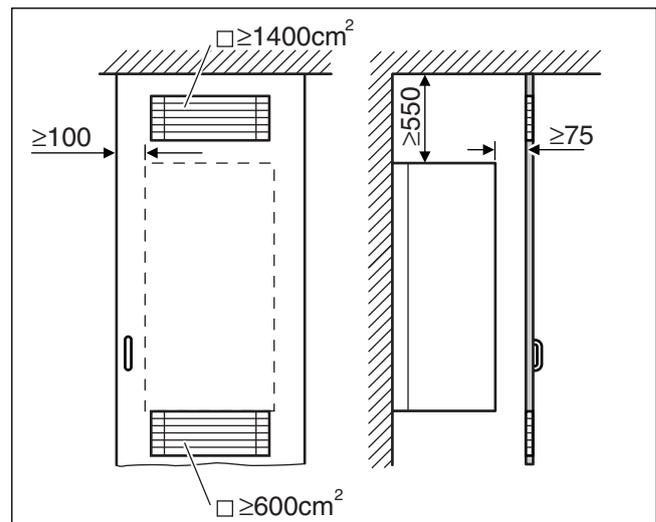
Рис. 8 Вентиляционные отверстия при установке в шкафу
