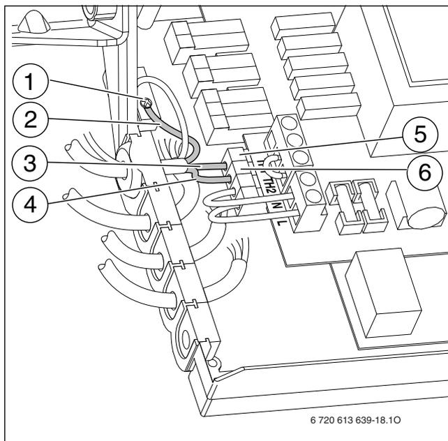
Рис. 18 Подключение сетевого кабеля 230 В перем. тока
