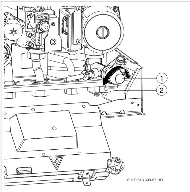
Рис. 45 Предохранительный клапан
