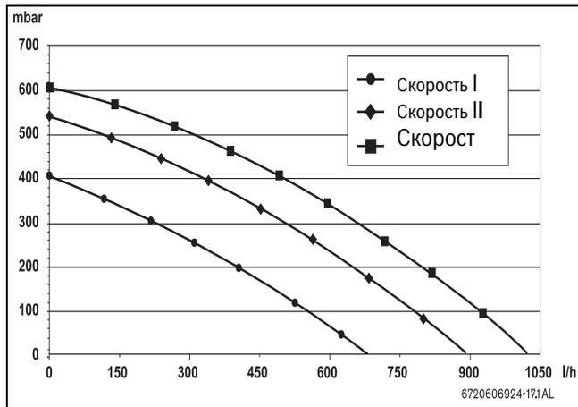
Рис. 5 Характеристика работы насоса
