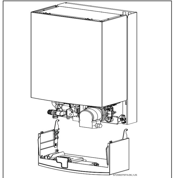
Рис. 10 Съем коробки панели управления
