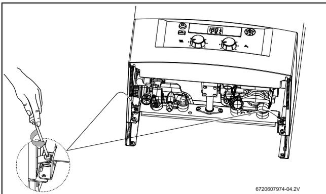
Рис. 8 Расположение винтов
