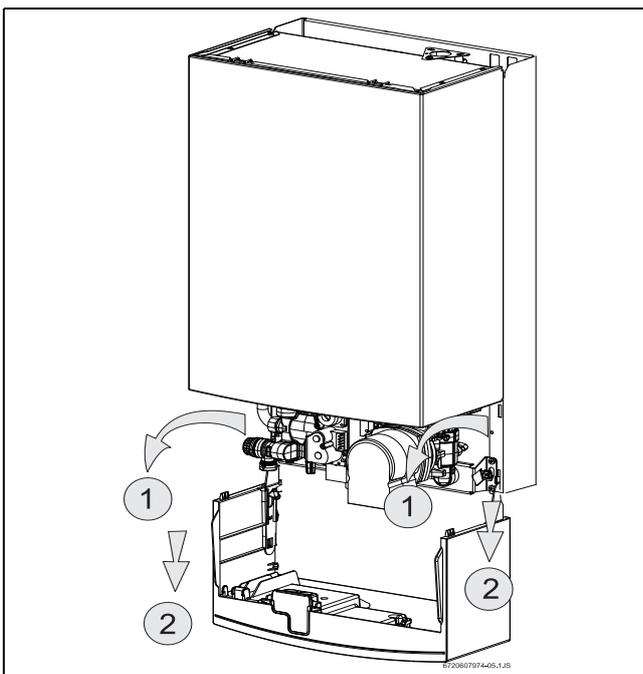
Рис. 9 Сервисное положение для доступа к системам водо- и электроснабжения.
