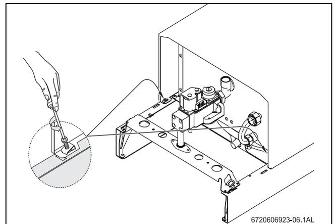
Рис. 11 Снять переднюю крышку
