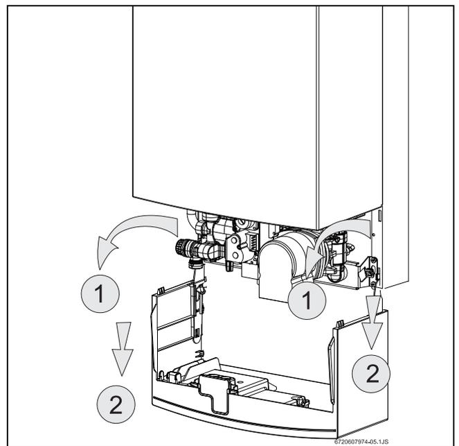
Рис. 30 Сервисное положение для доступа к системам водо- и электроснабжения
