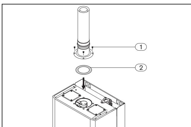
Рис. 14 Монтаж дроссельной шайбы
