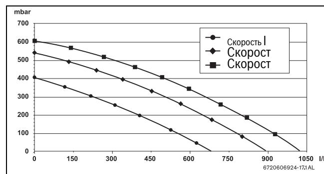
Рис. 6 Характеристика работы насоса
