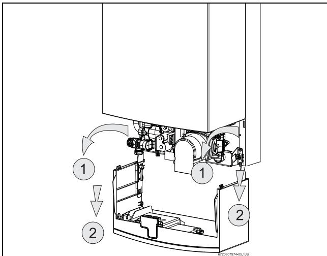
Рис. 33 Сервисное положение для доступа к системам водо- и электроснабжения
