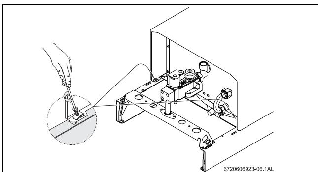
Рис. 12 Снять переднюю крышку
