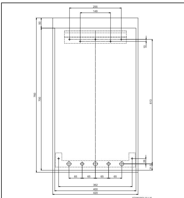
Рис. 8 Комплект для настенного монтажа
