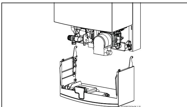
Рис. 11 Съем коробки панели управления
