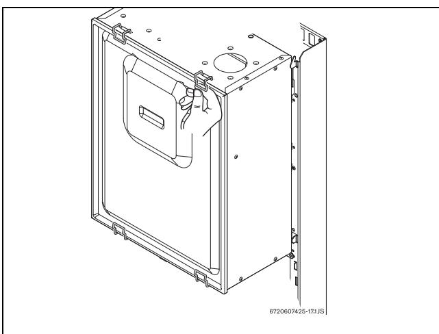
Рис. 30 Защитная панель
