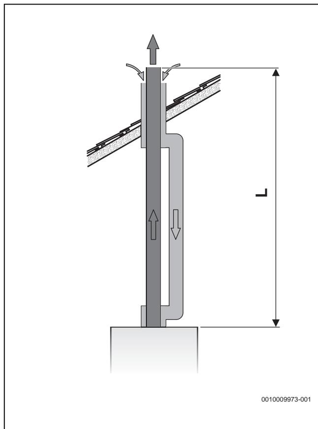
Рис. 15 Вертикальный отвод дымовых газов по C<sub>33</sub>
