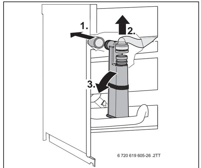
Рис. 59 Демонтаж конденсатного сифона
