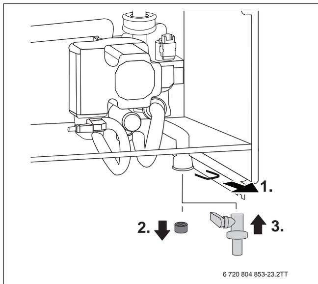
Рис. 25 Установка крана для заполнения и слива
