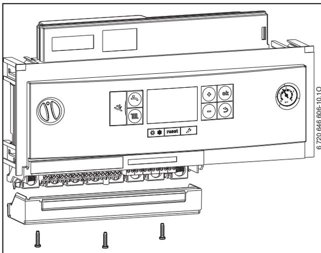
Рис. 70 Снятие крышки
