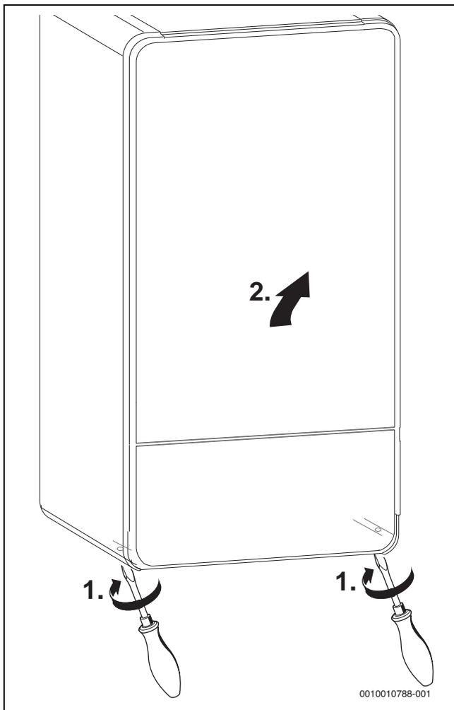
Рис. 22 Снятие облицовки
