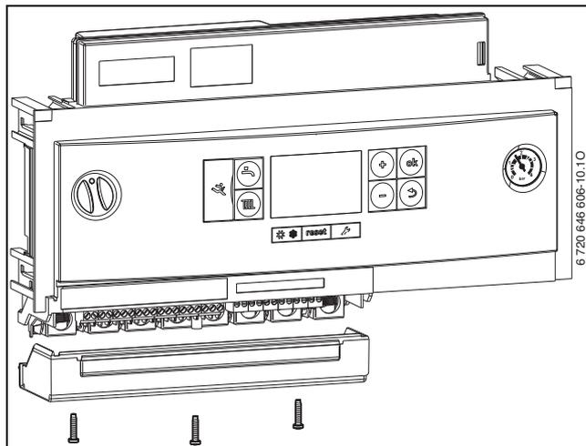
Рис. 29 Снятие крышки
