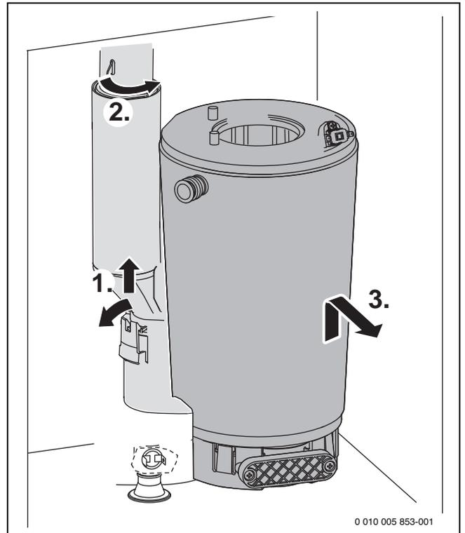
Рис. 76 Демонтаж теплообменника
