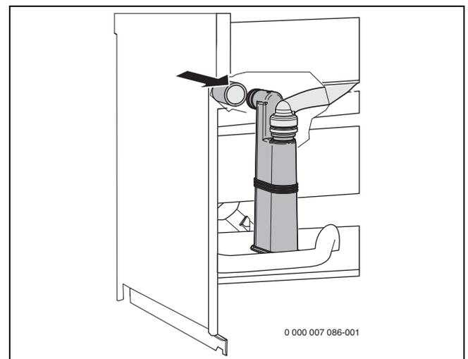
Рис. 24 Подсоединение шланга к конденсатному сифону
