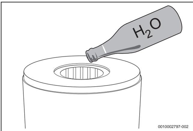
Рис. 58 Промывка теплообменника водой
