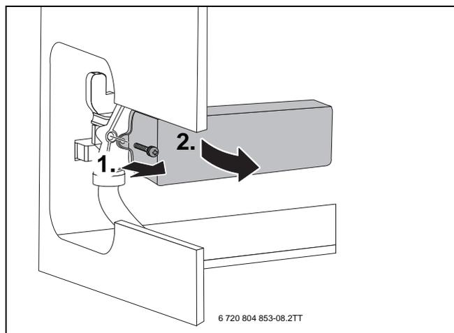
Рис. 61 Демонтаж пластинчатого теплообменника
