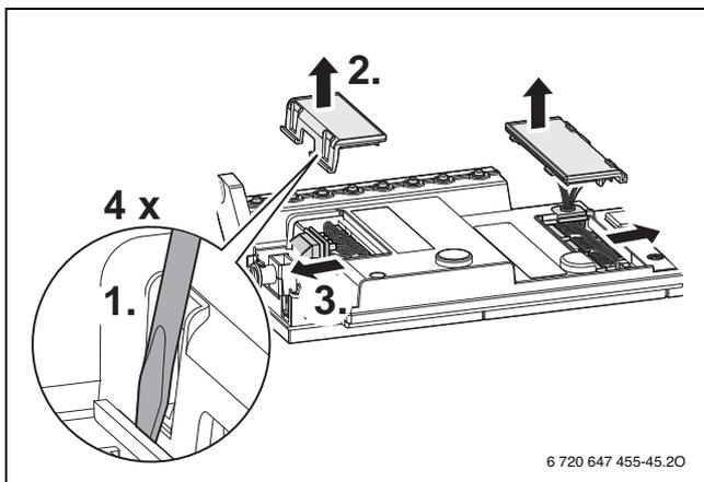
Рис. 72 Снятие крышки
