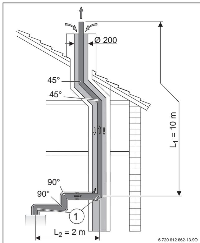
Рис. 17 Монтажная ситуация с отводом дымовых газов в шахте по C<sub>93</sub>
