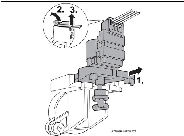
Рис. 65 Демонтаж сервопривода 3-ходового клапана
