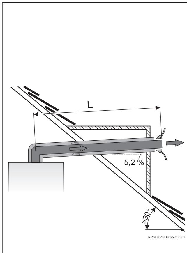
Рис. 12 Горизонтальный отвод дымовых газов по  $C_{13}$
