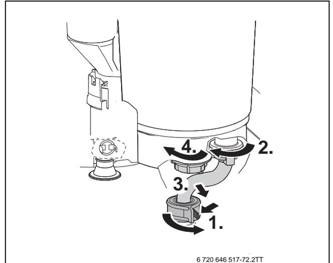
Рис. 75 Отверните гайку и отсоедините трубу обратной линии
