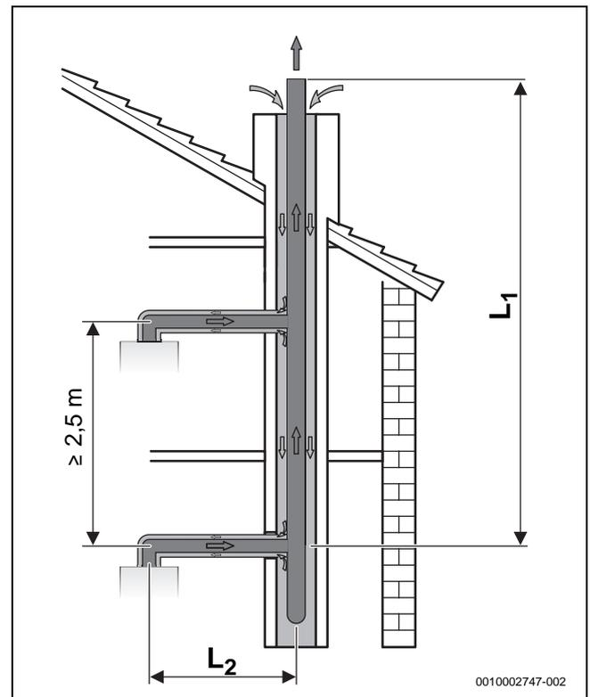
Рис. 18 Подключение нескольких устройств к одному дымоходу коаксиальной трубой по C<sub>43x</sub>
