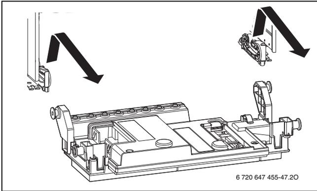
Рис. 73 Снимите блок управления
