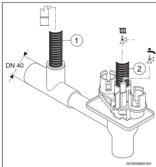
Рис. 26 Смонтируйте шланг слива конденсата и шланг от предохранительного клапана на сифон
