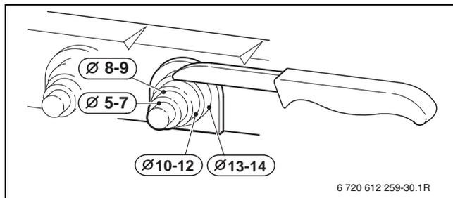
Рис. 30 Обрежьте фиксатор в соответствии с диаметром кабеля
