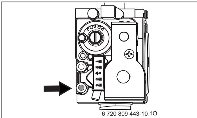
Рис. 47 Штуцер для выполнения замеров давления газа
